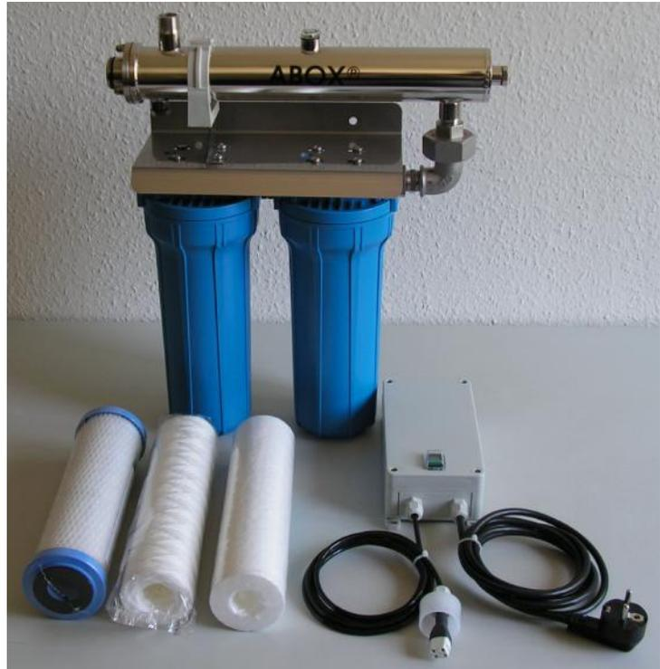
Für eine sichere Desinfektion mit UV-Licht muss das zu behandelnde Wasser eine gute UV-Durchlässigkeit aufweisen und frei von Schmutz- und Schwebstoffen sein. Dies erreicht man mit einer Vorfiltration. Das Kompaktgerät ABOX<sup>®</sup> WAS vereint die Vorfiltration und die UV-Desinfektion in einem gemeinsamen Gerät. Die kompakte, platzsparende Bauweise eignet sich vor allem für den Einbau auf Schiffen, in Ferienhäusern, Berghütten oder bei mobilem Einsatz.
